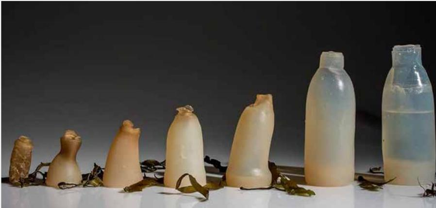
**Verpackung auf Basis von Meeresalgen: „Agar Plasticity“ ist ein Materialforschungsprojekt, in dem Agar als Alternative zu synthetischen Kunststoffen erforscht wird. Ari Jonsson hat das Konzept für eine Wasserflasche aus Agar-Agar entwickelt, die nach Gebrauch innerhalb von wenigen Tagen verrottet.**
